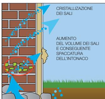
Nei vecchi edifici la causa più frequente del degrado delle murature e degli intonaci è la risalita capillare.
